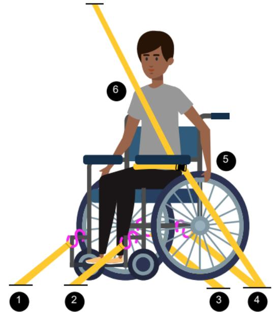
Siempre utilice las **seis (6)** correas de aseguramiento tanto en la silla de ruedas manual como en la motorizada.
