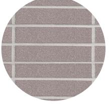
**SILL WALL MASONRY** STACK BOND
