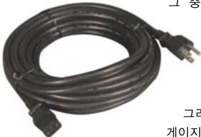
연장코드의 굵기가 연결된 전기제품의 전기 수요량에 적합한 지를 판단하기 위해서는 그 코드에 꽂힌 전등이나 제품의 축수 전부의 총 합계를 120으로 나누어서 총 암페어 수치를 계산해 보세요. 만일 그 총 암페어 수치가 코드의 규정 최고치와 같거나 그 보다 크면 그 코드보다 굵은 코드를 사용해야 합니다.
