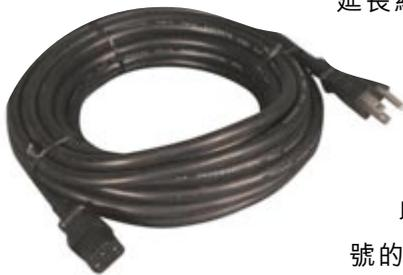
延長線有各種不同的電線尺寸稱為規號 (gauges)。最常見的為 18, 16, 14, 12 和 10。規號越小,電線能承載的電流(安培數)越大。所以,12規號的電線要比14規號的電線重。因此,16規號的延長線可以用來連接臺燈。這和電圓鋸有明顯的不同,電圓鋸將需要更多的功率,因此應使用粗大的12規號延長線。
