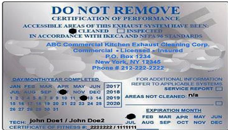
维修公司完成维修后会在风罩上贴上的标签。
