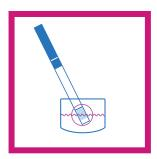
3. 將試紙浸入水中 15 秒。試紙浸入水中的部分不要超過波浪線。
