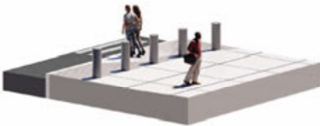
Bolardos con clasificación de choque (M50)
