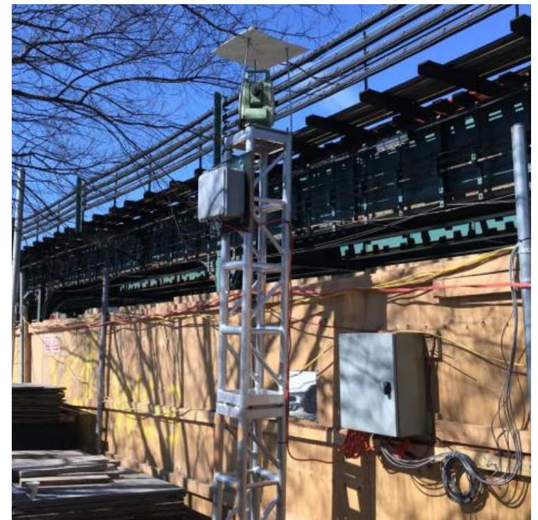
Instalación típica de pedestal de ATMS
