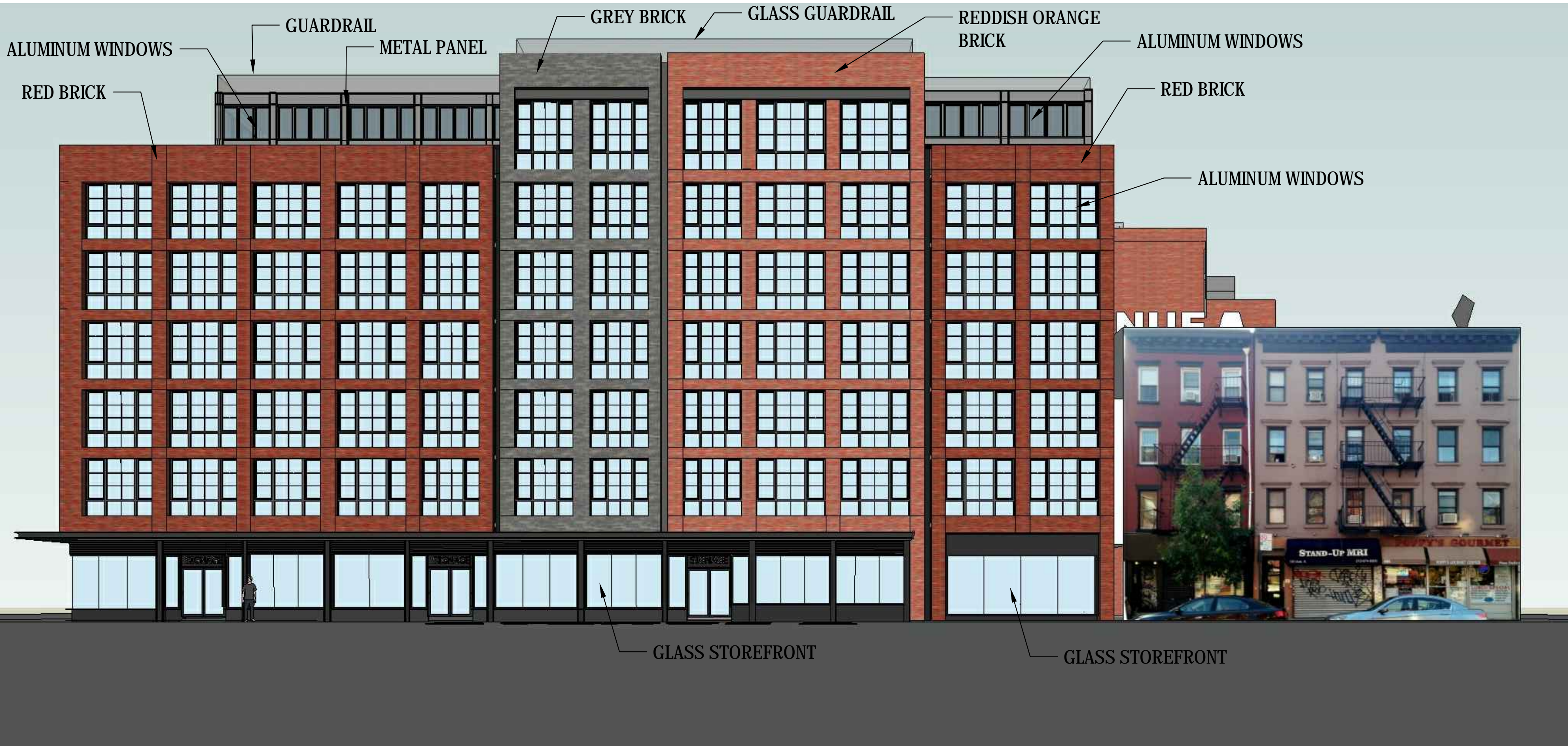
3 AVENUE A. EAST ELEVATION SCALE: 1/8" = 1'-0"
