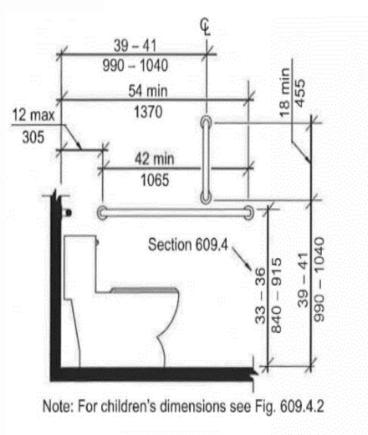
FIGURE 604.5.1 SIDE WALL GRAB BAR FOR WATER CLOSET
